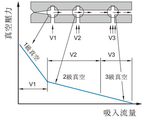
不同真空壓力(-kPa)的真空流量(ℓ/min)：
